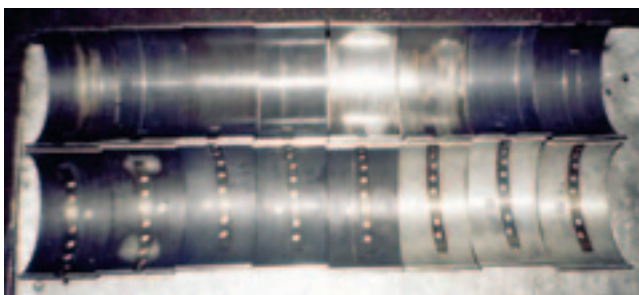
Рис. 2. Внешний вид шатунных вкладышей со сплавом АО20-1 после 9-летней эксплуатации на дизель-генераторе 1А-9ДГ (пробег 600 тыс. км). Износ рабочей поверхности — примерно 0,02 мм
