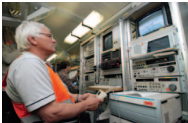
Рис. 2. Измерение параметров контактной сети в поезде ICE-S на линии Франкфурт-на-Майне — Кёльн (фото DBAG, Буссе)
