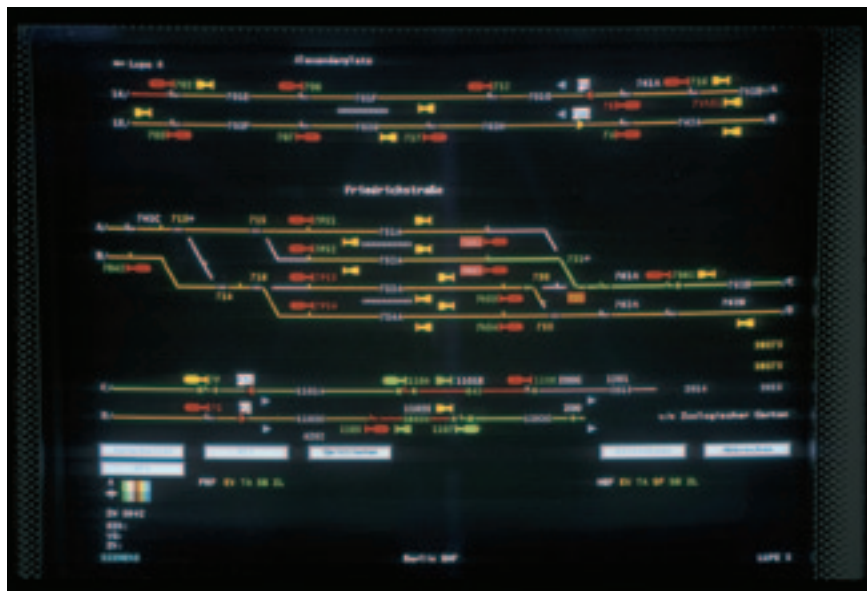
Рис. 2. Схема путей с данными графика движения поездов
