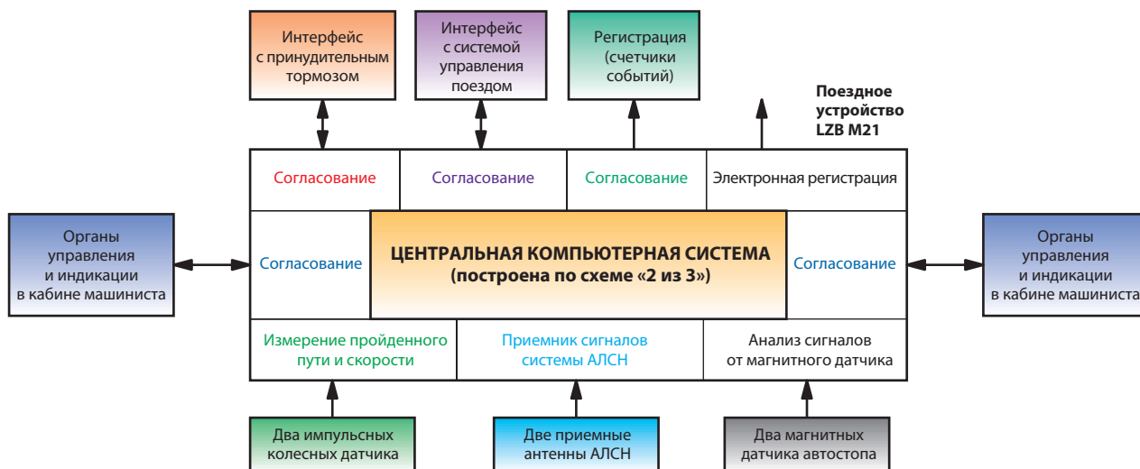
Рис. 3. Функциональная структура устройства АЛСН для поездов серий А и В
