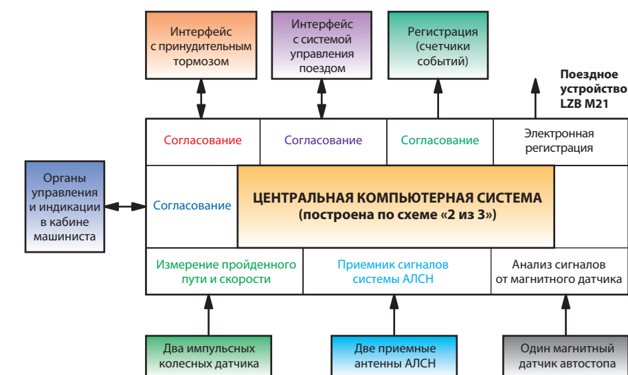
Рис. 4. Функциональная структура устройства АЛСН для поездов серии С
