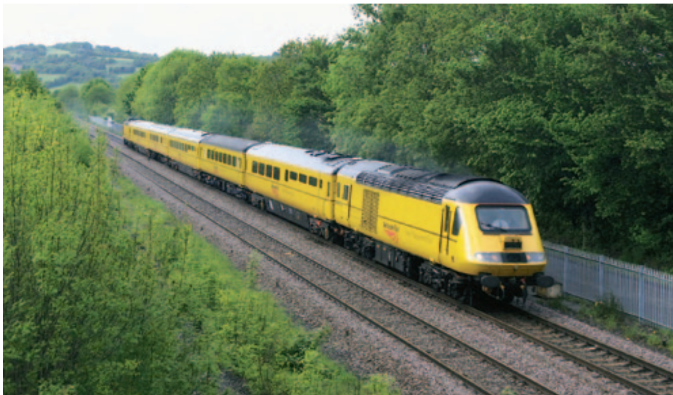
Рис. 1. Новый путеинспекционный поезд компании Network Rail
