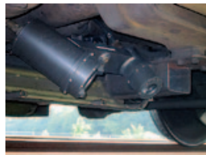
Рис. 3. Лазерный излучатель и приемная видеокамера системы LaserRail 3000
