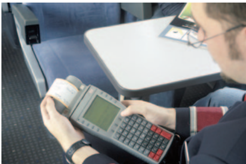
Рис. 3. Носимый терминал для продажи билетов в поездах местных сообщений (фото: DBAG, Вебер)
