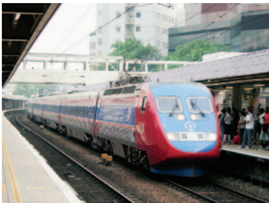
Рис. 2. Первый китайский скоростной электропоезд серии X2000, построенный по технологии компании ABB (Швеция)
