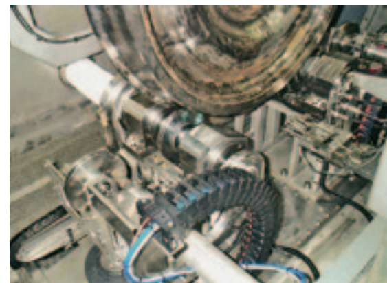
Рис. 3. Обследование колеса на стенде типа RWI
