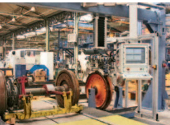
Рис. 1. Стенд типа AURA для ультразвуковой дефектоскопии моторных колесных пар на заводе DBAG в Крефельде
