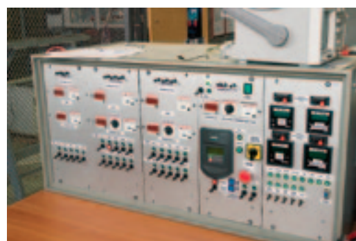
Рис. 6. Пульт управления испытательного стенда
