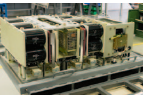
Рис. 3. Транзисторный модуль преобразователя
