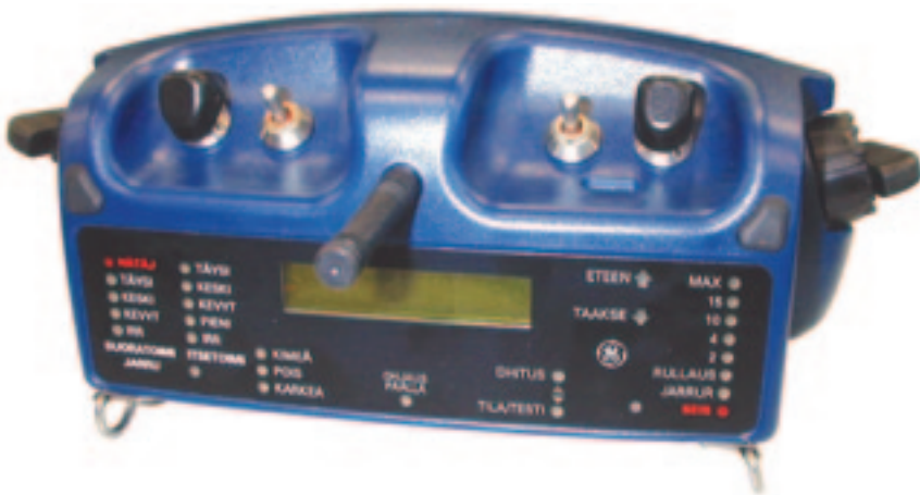
Рис. 2. Портативный пульт дистанционного управления локомотивом системы LOCOTROL RCL компании General Electric
