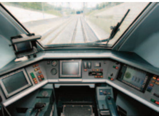
Рис. 2. Пульт управления с аппаратурой ETCS в кабине машиниста электропоезда ICN во время опытной поездки по линии Маттштеттен — Ротрист (фото: SBB)
