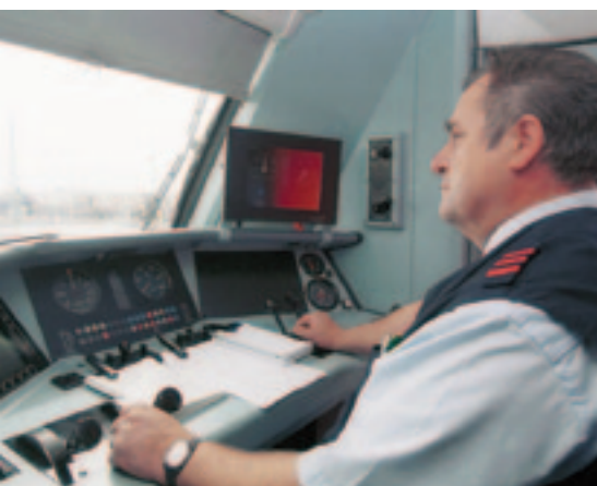
Рис. 1. Пульт управления с аппаратурой ETCS на локомотиве серии 101 железных дорог Германии (фото: DBAG, Буссе)
