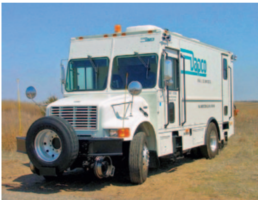
Рис. 3. Машина-дефектоскоп компании DAPCO Rail Services на комбинированном автомобильно-рельсовом ходу «в поле»
