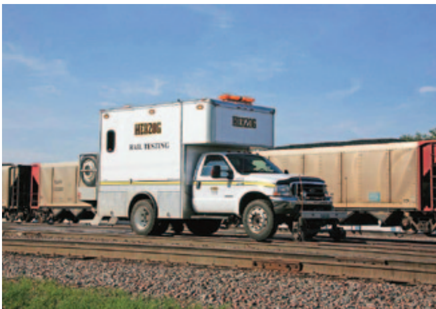
Рис. 4. Машина-дефектоскоп корпорации Herzog Services на комбинированном ходу в работе
