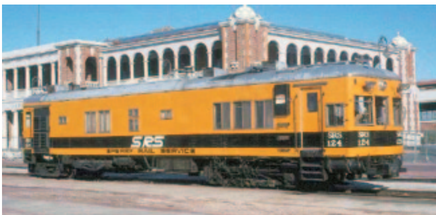
Рис. 5. Вагон-дефектоскоп корпорации Sperry Rail Service
