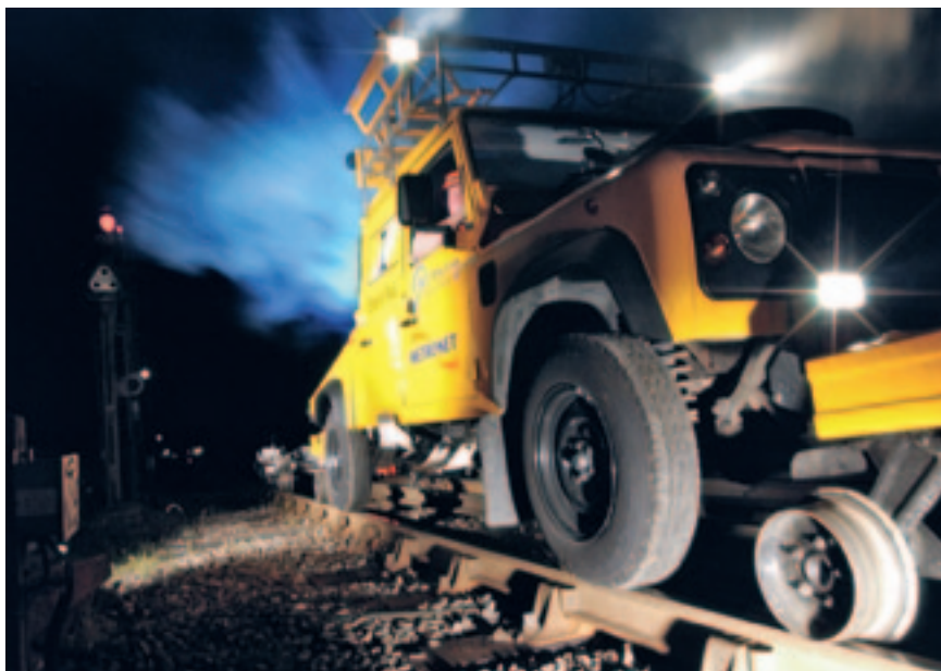
Рис. 6. Машина-дефектоскоп корпорации Sperry Rail Service на базе автомобиля Land Rover в тоннеле Лондонского метрополитена
