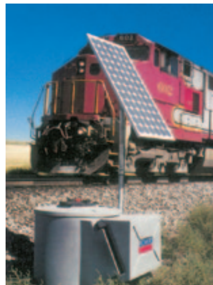
Рис. 2. Рельсовый лубрикатер корпорации Lincoln Industrial с питанием от солнечной батареи
