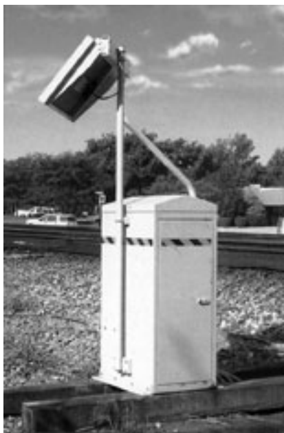
Рис. 1. Рельсовый лубрикатер типа Lubricurve Electro 20
