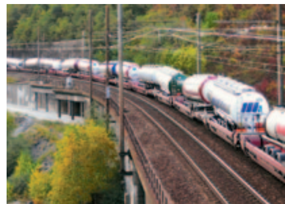
Рис. 1. Перевозка автопоездов по технологии route roulante
