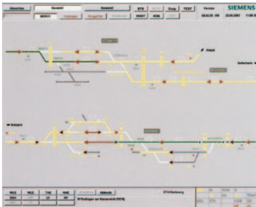
Рис. 7. Обзорное изображение схемы путей на экране монитора поездного диспетчера
