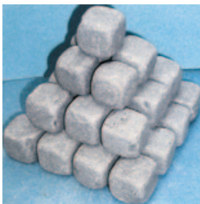
Рис. 2. Кубические образцы твердых пород после испытаний по методу LA в машине Deval
