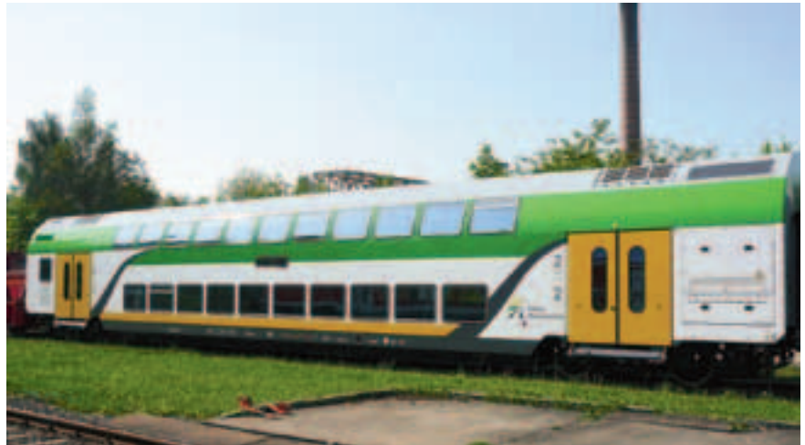
Рис. 7. Двухэтажный промежуточный пассажирский вагон постройки Bombardier Transportation для компании-оператора Koleje Mazowieckie (фото: Bombardier)
