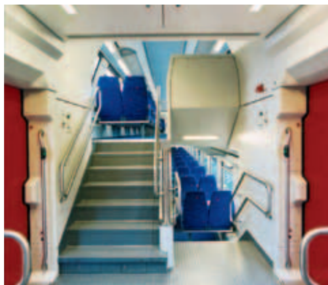
Рис. 5. Входная площадка с лестницами на первый и второй этажи (фото: Bombardier)
