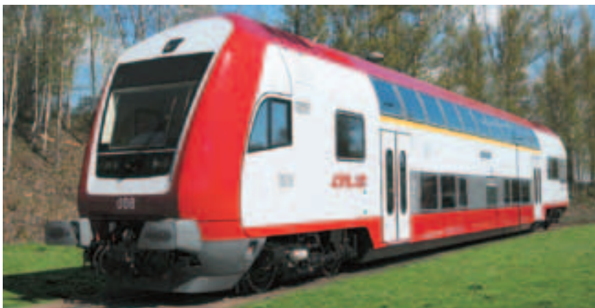
Рис. 2. Двухэтажный хвостовой пассажирский вагон с кабиной управления постройки Bombardier Transportation для железных дорог Люксембурга (фото: Bombardier)
