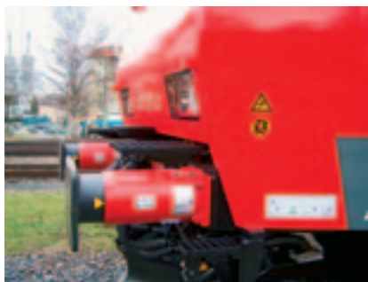
Рис. 1. Энергопоглощающие буфера на электровозе серии 185 железных дорог Германии
