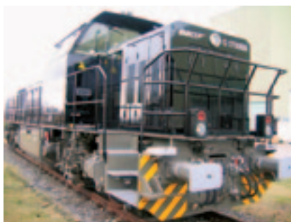
Рис. 2. Маневровый тепловоз серии G1700 ВВ компании MRCE, оснащенный энергопоглощающими буферами
