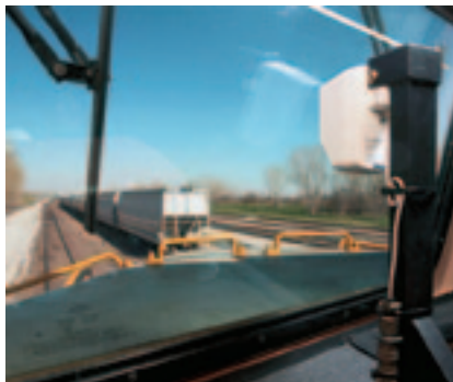
Рис. 4. Устройство Track Image Recorder в кабине локомотива железной дороги Union Pacific (фото: UP)
