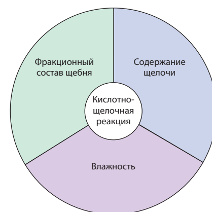
Условия возникновения и компоненты кислотно-щелочной реакции в бетоне
