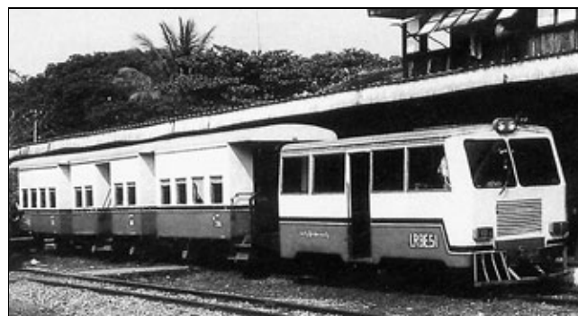
Рис. 3. Рельсовый автобус, построенный на базе грузового автомобиля, в сцепе с пассажирскими вагонами
