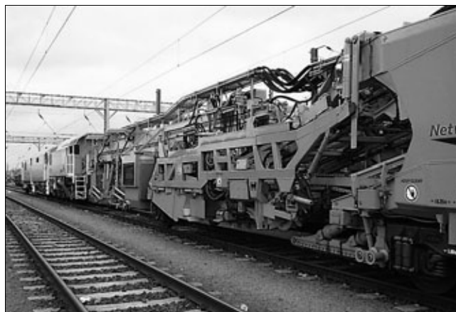
Путеукладочный поезд P95UK
