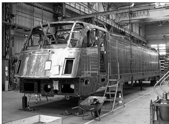
Рис. 3. Изготовление кузова первого электровоза ES64U4 на заводе Siemens в Мюнхене
