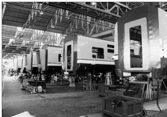
Рис. 2. Сборка кузовов вагонов поездов 2900 на заводе компании CAF в Беасайне
