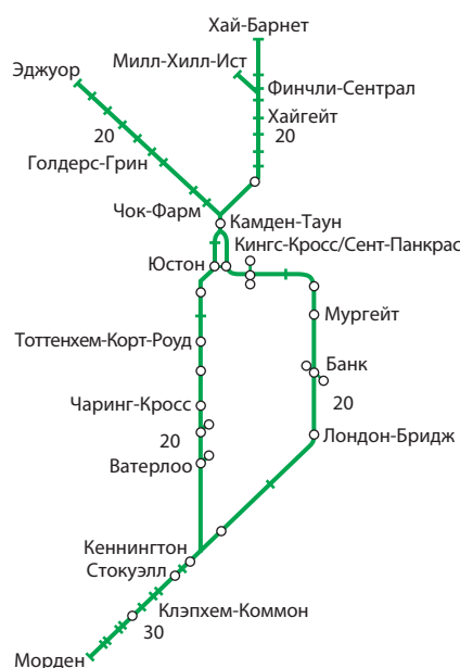
Рис. 5. Схема линии Northern с указанием основных станций и плотности движения поездов (поездов в час в каждом направлении) на отдельных участках
