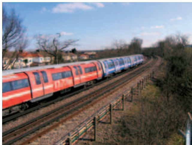
Рис. 4. Первый удлиненный поезд типа 1996 Stock линии Jubilee в специальном оформлении (дополнительный вагон имеет отличающуюся окраску)
