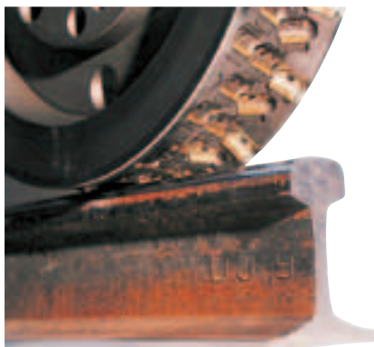
Рис. 1. Рельсофрезеровальная головка компании Linsinger (фото: Linsinger)
