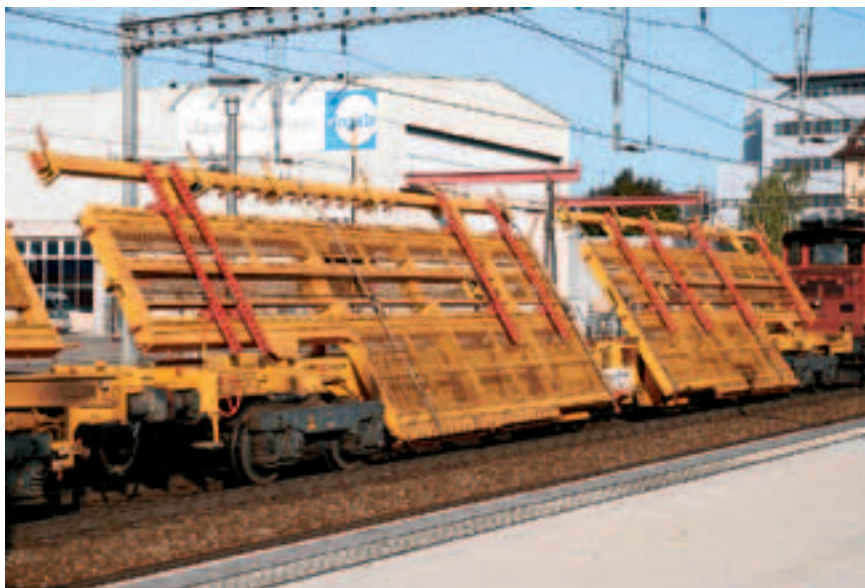
Рис. 4. Вагон-платформа для перевозки стрелочных переводов и глухих пересечений в сборе
