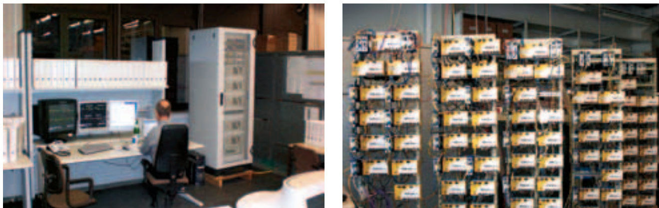
Рис. 9. Центр тестирования. Слева — рабочее место оператора, справа — программируемые контроллеры и модули ввода-вывода на испытательных стендах
