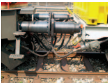
Рис. 2. Соединение грузовой секции с локомотивом
