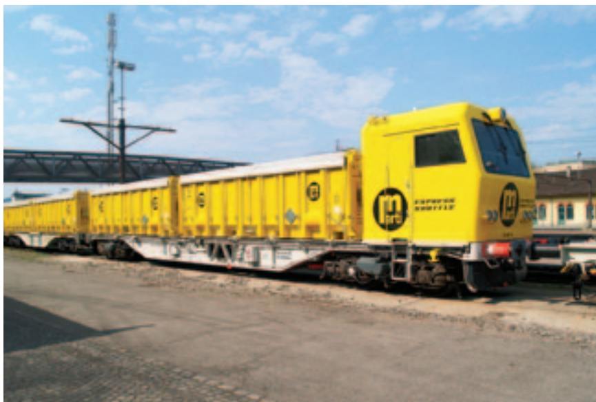
Рис. 3. Головной вагон СТW с кабиной управления и дизельным агрегатом
