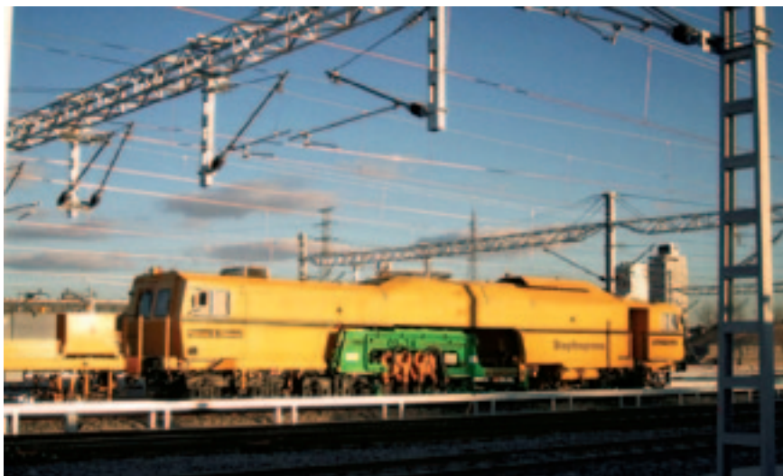
Рис. 1. Машина типа 09-3X компании Plasser & Theurer
