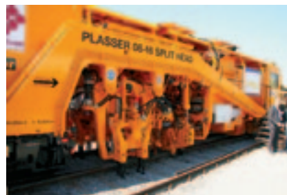
Рис. 2. Машина типа 08-16 SH компании Plasser & Theurer
