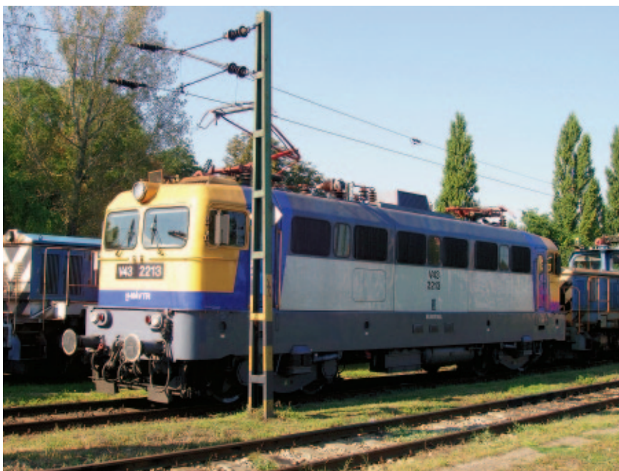
Рис. 2. Электровоз компании MÁV с поперечно установленным на крыше вакуумным выключателем CVB
