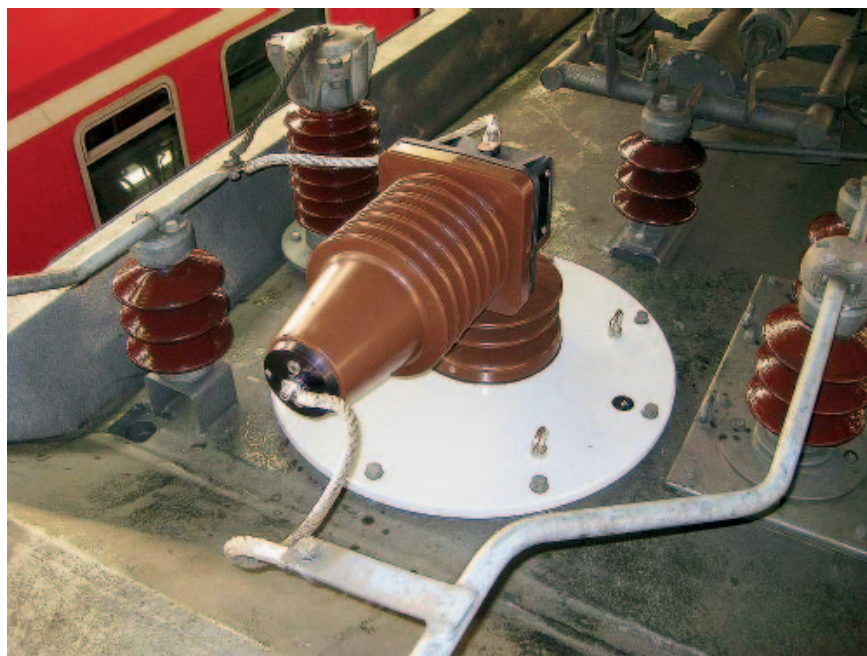
Рис. 1. Вакуумный выключатель CVB, установленный продольно на крыше электровоза компании MEG
